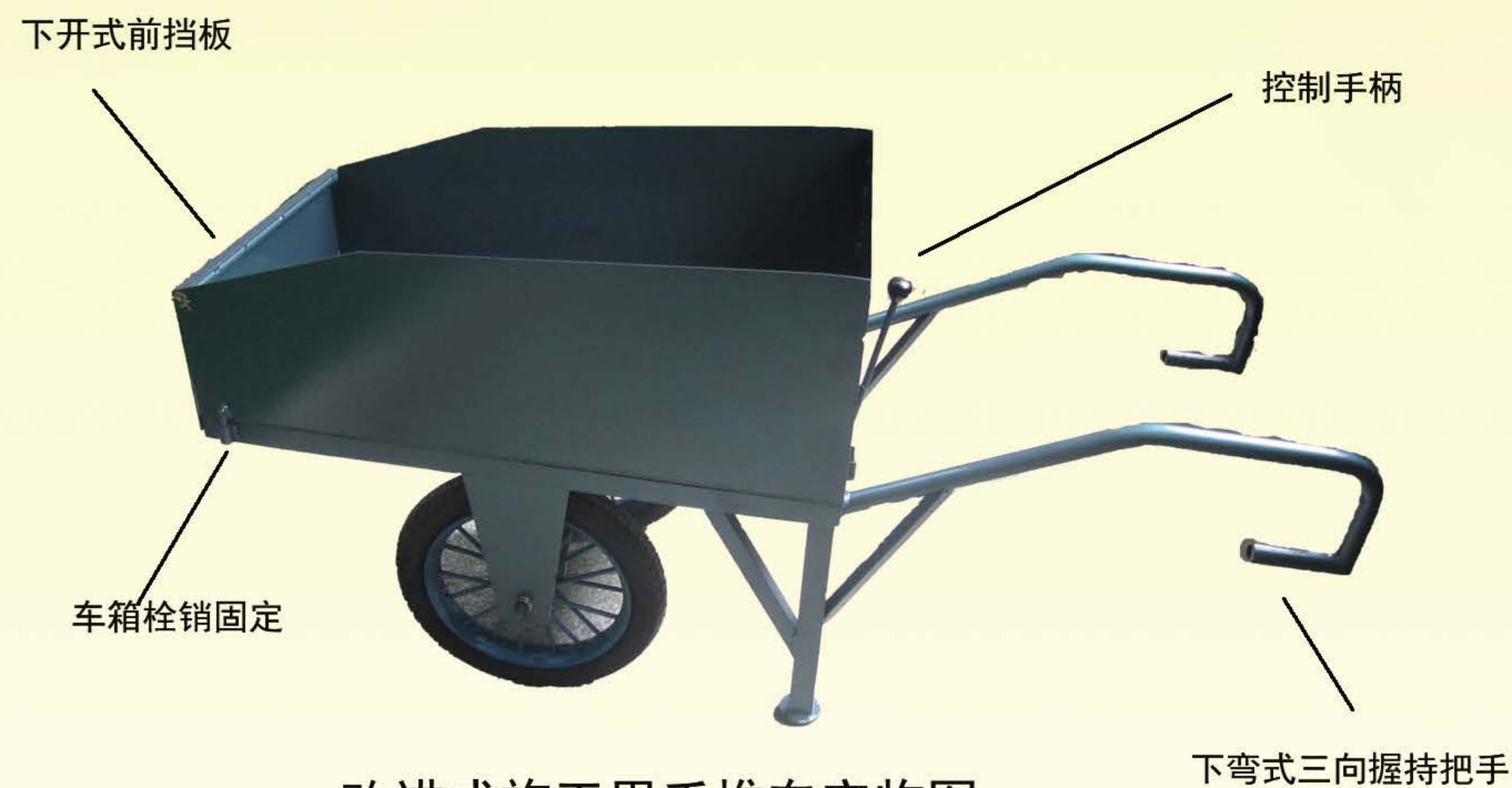
改进式施工用手推车实物图
