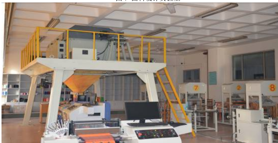
图 8 先进的 6144 针电子大提花织造样机
